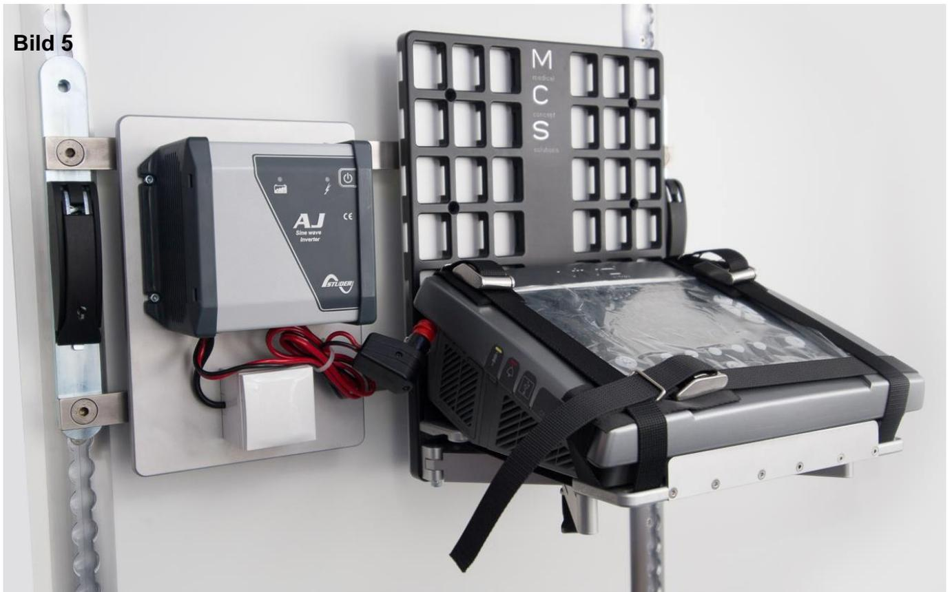
Das Bild 5 zeigt das **Halterungssystem V1** mit dem fixierten Heimbeatmungsgerät VIVO 50 sowie dem Spannungswandler für die Sicherstellung der Stromversorgung während der Verlegungsfahrt.
